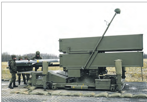
Заряжание пусковой установки ЗРК «Насамс»
