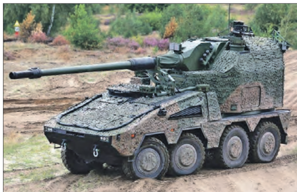
155-мм самоходная гаубица RCH-155 на базе БТР «Боксер»
