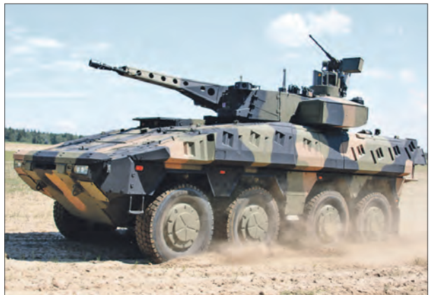
БМБ «Боксер» в варианте БМП с 30-мм пушкой
