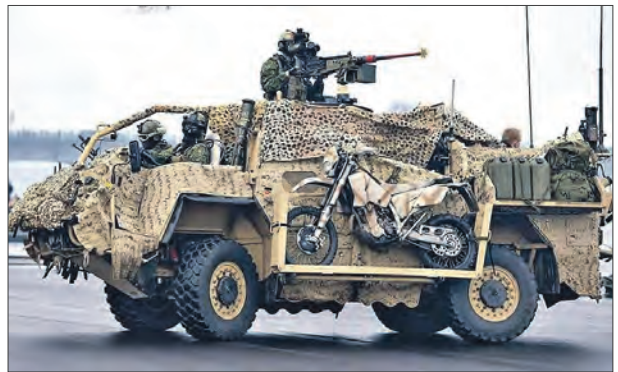
Броневый автомобиль «Шакал-2», дооборудованный креплением для мотоцикла
