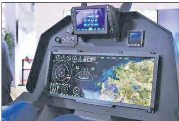
Макет приборной панели многоцелевого истребителя «Цзянь-20»
