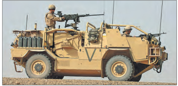
Тактический броневый автомобиль «Шакал» с навесным комплектом бронирования
