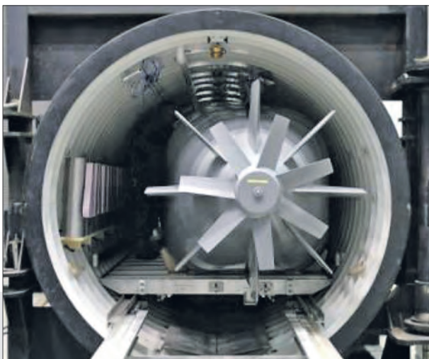
Размещение ПСД Mk 11 в увеличенной док-камере
